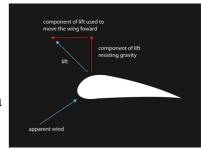
Data la sua velocità, la punta della pala è la parte più efficace di una turbina eolica. In alcuni casi l'ultimo 25% della pala è responsabile per il 75% dell'energia generata. Il sistema alare mima la traiettoria e la velocità di queste punte di pale, sfruttando tutti i benefici usando solo una frazione del materiale.
