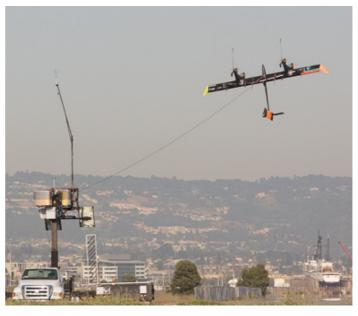
Durante il volo di vento trasversale, l'AWT vola attraverso il vento in una *traiettoria circolare* uguale a quella compiuta dalla punta di una turbina eolica convenzionale. I *rotori* sono utilizzati per produrre energia rallentando la velocità del sistema alare. L'ala raccoglie energia cinetica creando ascensione e guadagnando energia, che la farebbe accelerare.
