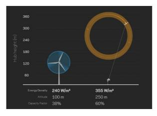
In scala, l'intera apertura alare del sistema alare Makani opera alla velocità della punta di una turbina eolica efficacemente aerodinamica. L'energia è estratta dal sistema usando piccole turbine di guida ad alta velocità, funzionanti come generatori a trasmissione diretta. L'elettricità è trasmessa al terreno attraverso il cavo.
