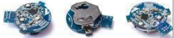
Utilizzando la tecnologia Bluetooth Low Energy (BLE), il dispositivo può stimare la posizione degli smartphone ed interagire con essi scambiando dati ed informazioni.
